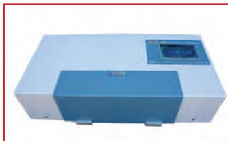
**Автоматический поляриметр AA-55** с сенсорным дисплеем не требует квалифицированного персонала для получения точных и воспроизводимых данных: Угловая шкала:  $\pm 90^\circ$ , с разрешением  $\pm 0,01^\circ$ . Сахарная шкала:  $\pm 250^\circ Z$ , с разрешением  $\pm 0,01^\circ Z$ .
