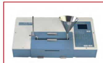
**Автоматические рефрактометры PTR-46 и PTR-46X** работающие по принципу критического угла, что позволяет анализировать темные образцы также просто, как и прозрачные. Наличие контроля температуры образца в диапазоне от 15 до 50°C. Точность **PTR-46** — 0.0001RI и 0.1 Brix, **PTR-46X** — 0.00005RI и 0.05 Brix.
