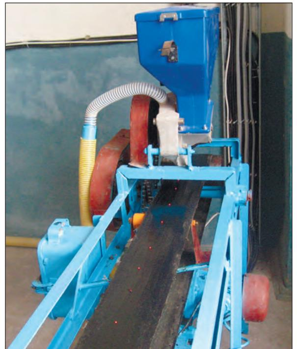
Рис. 4. Стенд для моделирования качества высева семян
