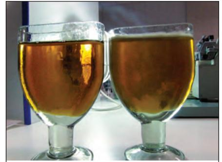
Рис. 3. Пробы сиропа: слева – после фильтрования на ФС-2000 с использованием фильтроперлита, справа – нефильтрованная проба
