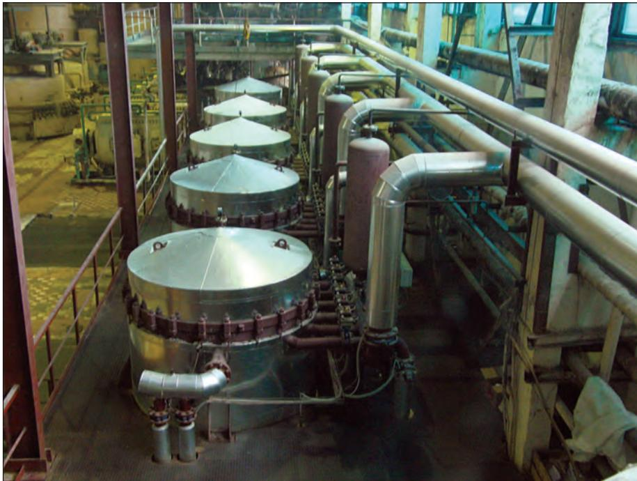
Рис. 2. Установка для фильтрования сиропа на базе фильтров ФС-2000
