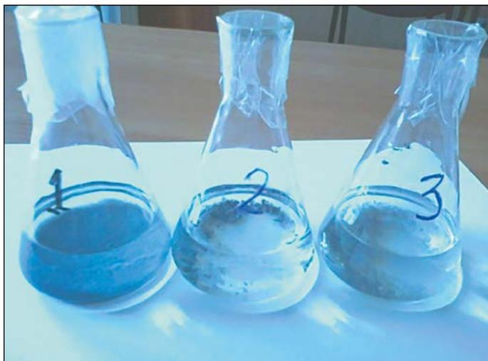
Рис. 2. Коллоиды: 1 – клеточного сока, 2 – жомопрессовой воды, 3 – диффузионного сока
