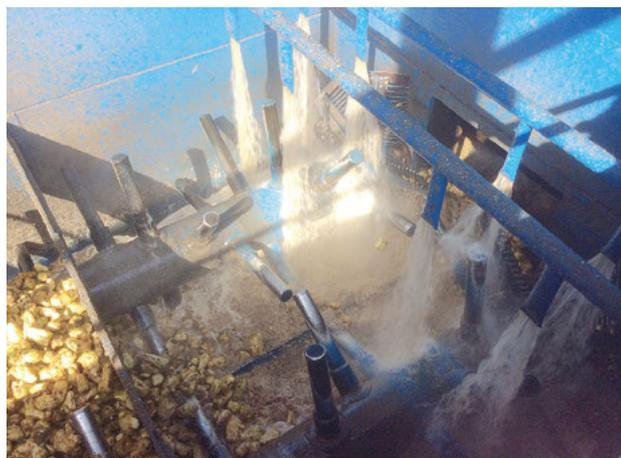
Рис. 4. Мойка корытная двухвальная ТМА-ПМД-10, общий вид и в процессе эксплуатации
