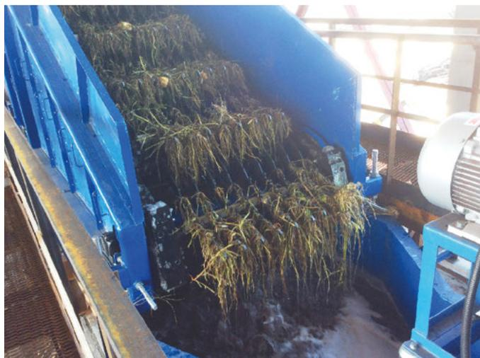
Рис. 3. Соломоботволовушка ТМА-СБТ-900 в работе
