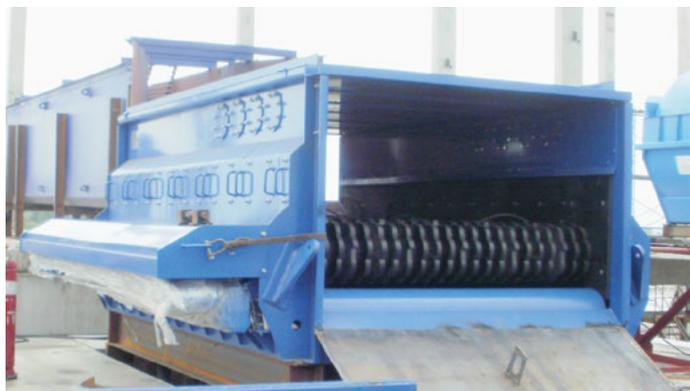
Рис. 5. Водоотделитель ТМА-ВДФ-10
